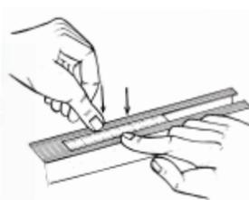
Inserire il metro tagliato in misura M1 nelle 2 cave della barra anteriore, portandolo fine a fine corsa.
