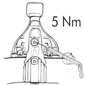
Stringere la vite superiore fino ad accompagnare la parte inferiore della ganascina al tetto. Stringere la vite inferiore arrivando a fine corsa. Stringere con forza la vite di congiunzione della ganascina. Stringere con forza la vite superiore facendo **ATTENZIONE** a non spostare la centratura delle barre. Per ottenere il risultato corretto stringere le viti alternando il lato destro al lato sinistro in maniera uniforme.
