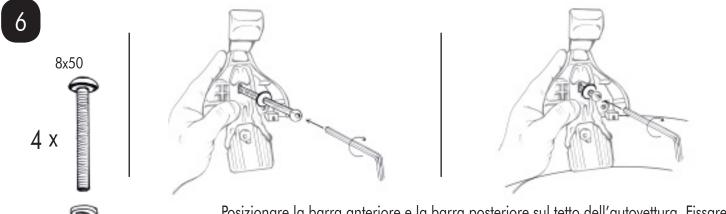
Posizionare la barra anteriore e la barra posteriore sul tetto dell'autovettura. Fissare le ganascine ai 4 piedi facendo ATTENZIONE a non stringere completamente la vite.
