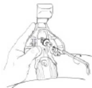
Posizionare la barra posteriore sul tetto dell'autovettura. Fissare le ganascine ai 2 piedi facendo **ATTENZIONE** a non stringere completamente la vite.
