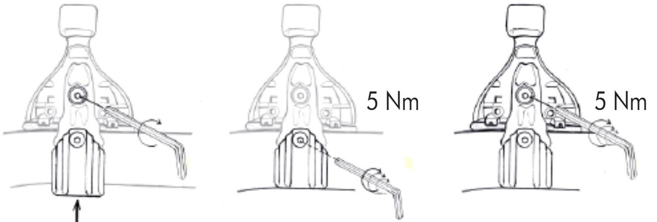
Stringere la vite superiore fino ad accompagnare la parte inferiore della ganascina al tetto. Stringere con forza la vite inferiore. Stringere con forza la vite superiore facendo **ATTENZIONE** a non spostare la centratura delle barre. Per ottenere il risultato corretto stringere le viti alternando il lato destro al lato sinistro in maniera uniforme.
