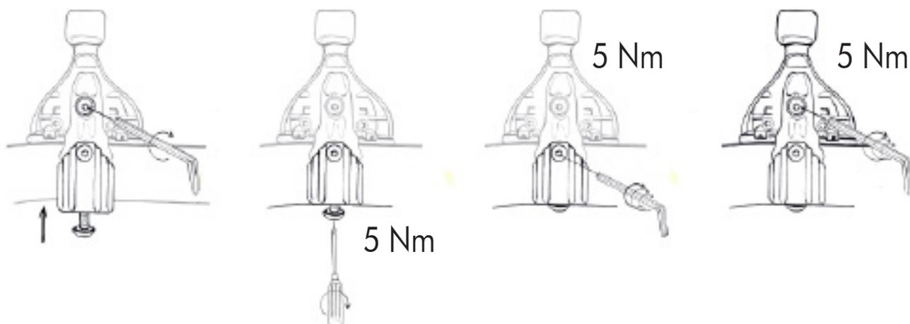
Stringere la vite superiore fino ad accompagnare la parte inferiore della ganascina al tetto. Stringere la vite inferiore arrivando a fine corsa. Stringere con forza la vite di congiunzione della ganascina. Stringere con forza la vite superiore facendo **ATTENZIONE** a non spostare la centratura delle barre. Per ottenere il risultato corretto stringere le viti alternando il lato destro al lato sinistro in maniera uniforme.
