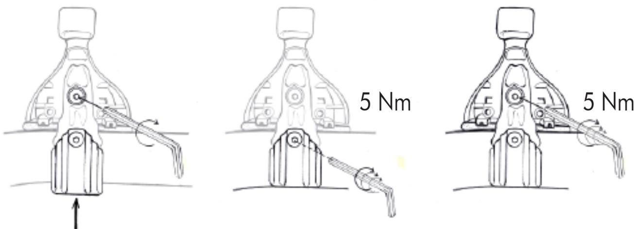
Stringere la vite superiore fino ad accompagnare la parte inferiore della ganascina al tetto. Stringere con forza la vite inferiore. Stringere con forza la vite superiore facendo **ATTENZIONE** a non spostare la centratura delle barre. Per ottenere il risultato corretto stringere le viti alternando il lato destro al lato sinistro in maniera uniforme.
