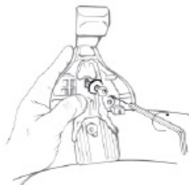
Posizionare la barra anteriore e la barra posteriore sul tetto dell'autovettura. Fissare le ganascine ai 4 piedi facendo **ATTENZIONE** a non stringere completamente la vite.
