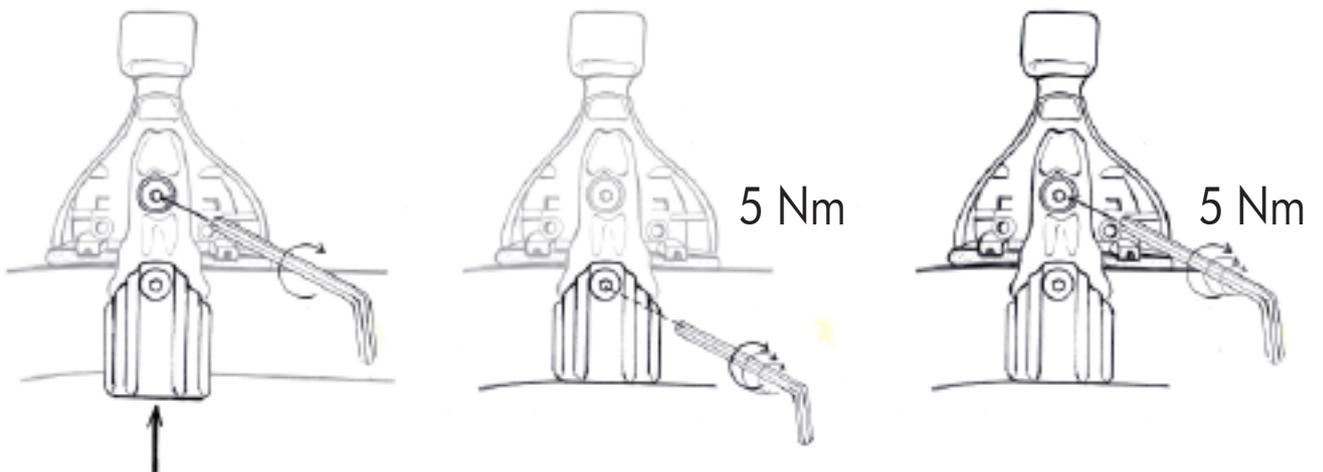
Stringere la vite superiore fino ad accompagnare la parte inferiore della ganascina al tetto. Stringere con forza la vite inferiore. Stringere con forza la vite superiore facendo **ATTENZIONE** a non spostare la centratura delle barre. Per ottenere il risultato corretto stringere le viti alternando il lato destro al lato sinistro in maniera uniforme.
